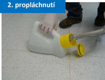
Položte nádobu na zem dle obrázku a připojte savky.
